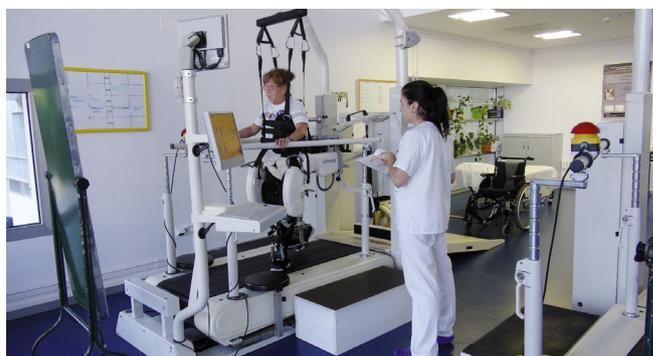
**Fig. 1. Dispositivo robótico de reeducación de la marcha Lokomat que consta de un treadmill, de un sistema de soporte parcial de peso y de un exoesqueleto de miembros inferiores con actuadores en caderas y rodillas.**
