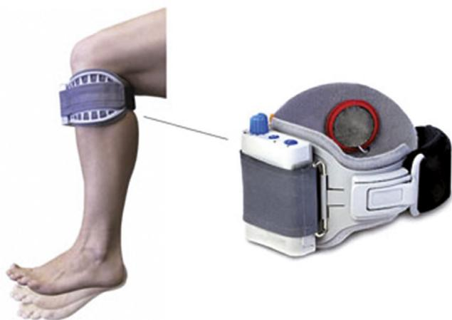
**Fig. 5. WalkAide System.** Consiste en un estimulador que realiza la estimulación a nivel del nervio peroneo para evocar las dorsiflexión del tobillo en la fase de oscilación de la marcha.
